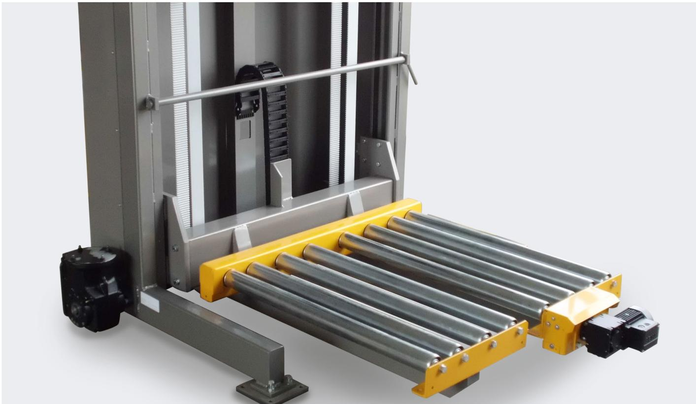
Heber mit Zahnriemenantrieb und Energiekette für den aufgesetzten Rollenförderer mit eigenem Antrieb
