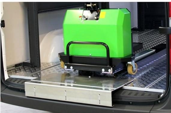
Selbstverständlich lässt sich der Innolift auch ohne Last auf- und abladen. So können Sie das Fahrzeug nacheinander mit Paletten be- und entladen. Ein optional erhältliches Überfahrblech überbrückt ggf. den Auftritt oder eine Anhängerkupplung.
