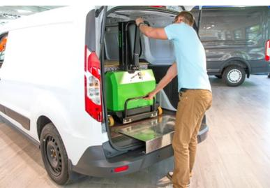
4. Den Innolift und die Last in das Fahrzeug schieben.
