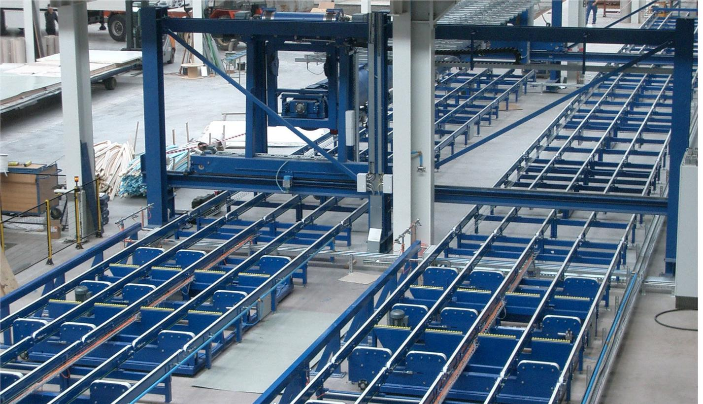
Zahnriemenförderer-Strecken mit Ausschleuser-Stationen für den Transport von großen Sandwichpaneelen
