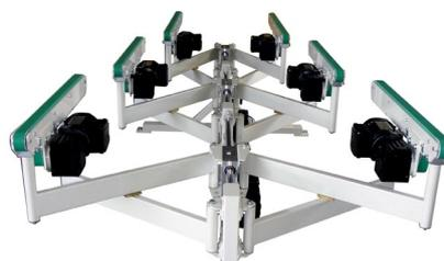
6 separate Zahnriemenfördererstränge in Breite elektromechanisch verstellbar
