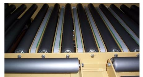
Ausschleuser mit 6 Strängen auf Hub, in Rollenbahn integriert
