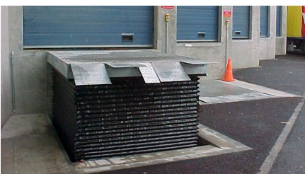
Grubeneinbau an einer Verladerampe
