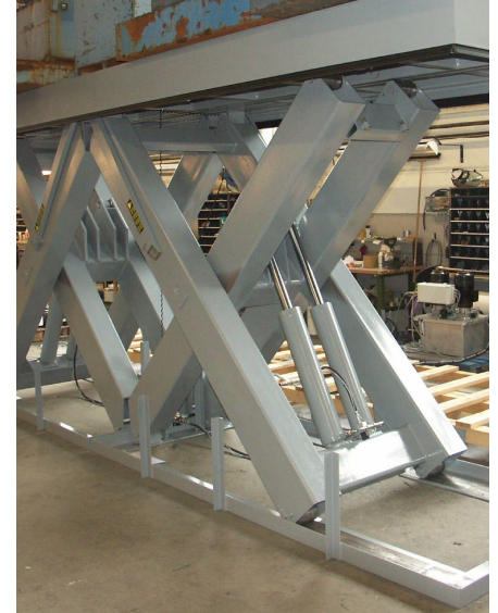
Massive Ausführung der Scherenpakete
