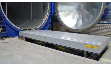
Hubtisch in Grubeneinbausituation
