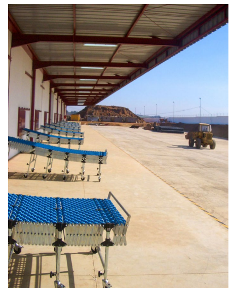
Gefällebahn mit Kunststoffröllchen
