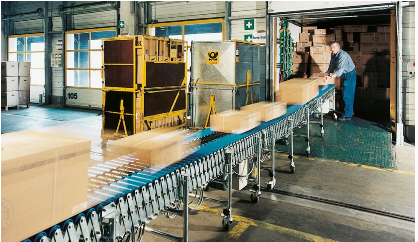
Angetriebene und gekoppelte Scherenrollenbahnen zur Entladung von Lieferfahrzeugen
