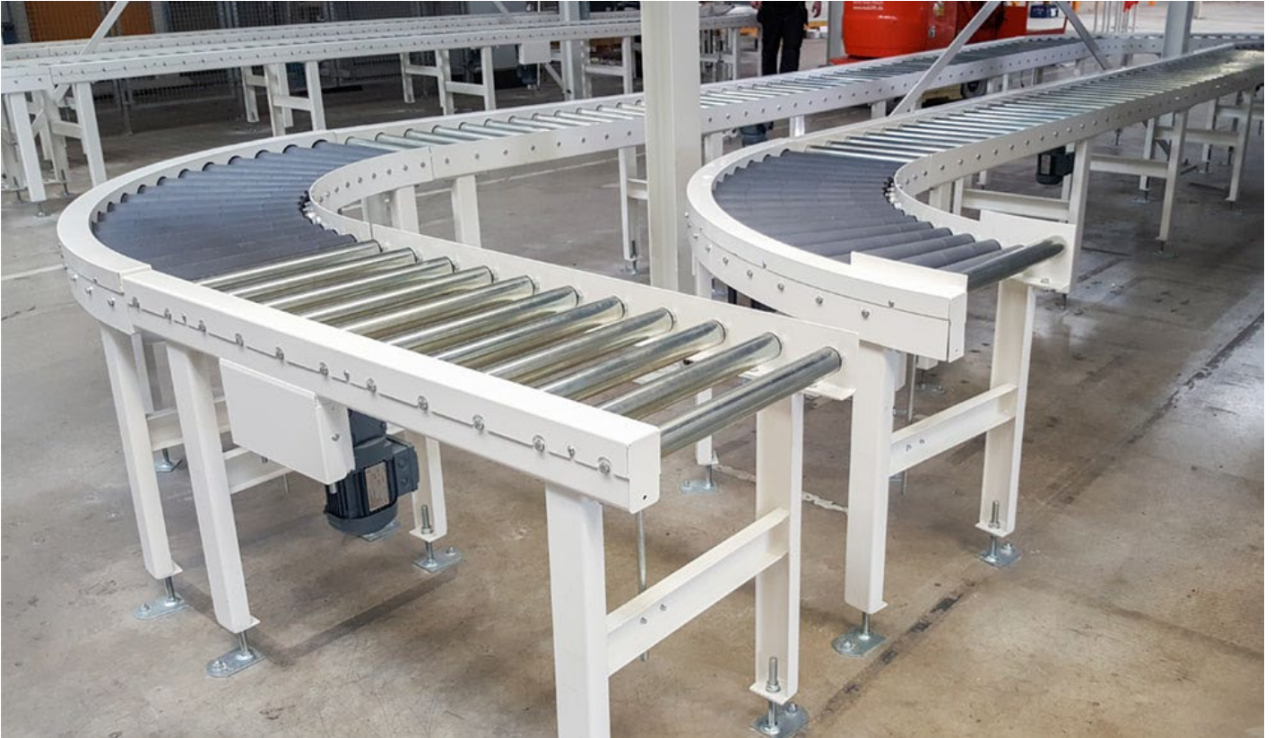
Rollenfördererkurve in Förderlinie integriert, mit Seitenführungen und Endanschlag durch eine erhöhte Tragrolle
