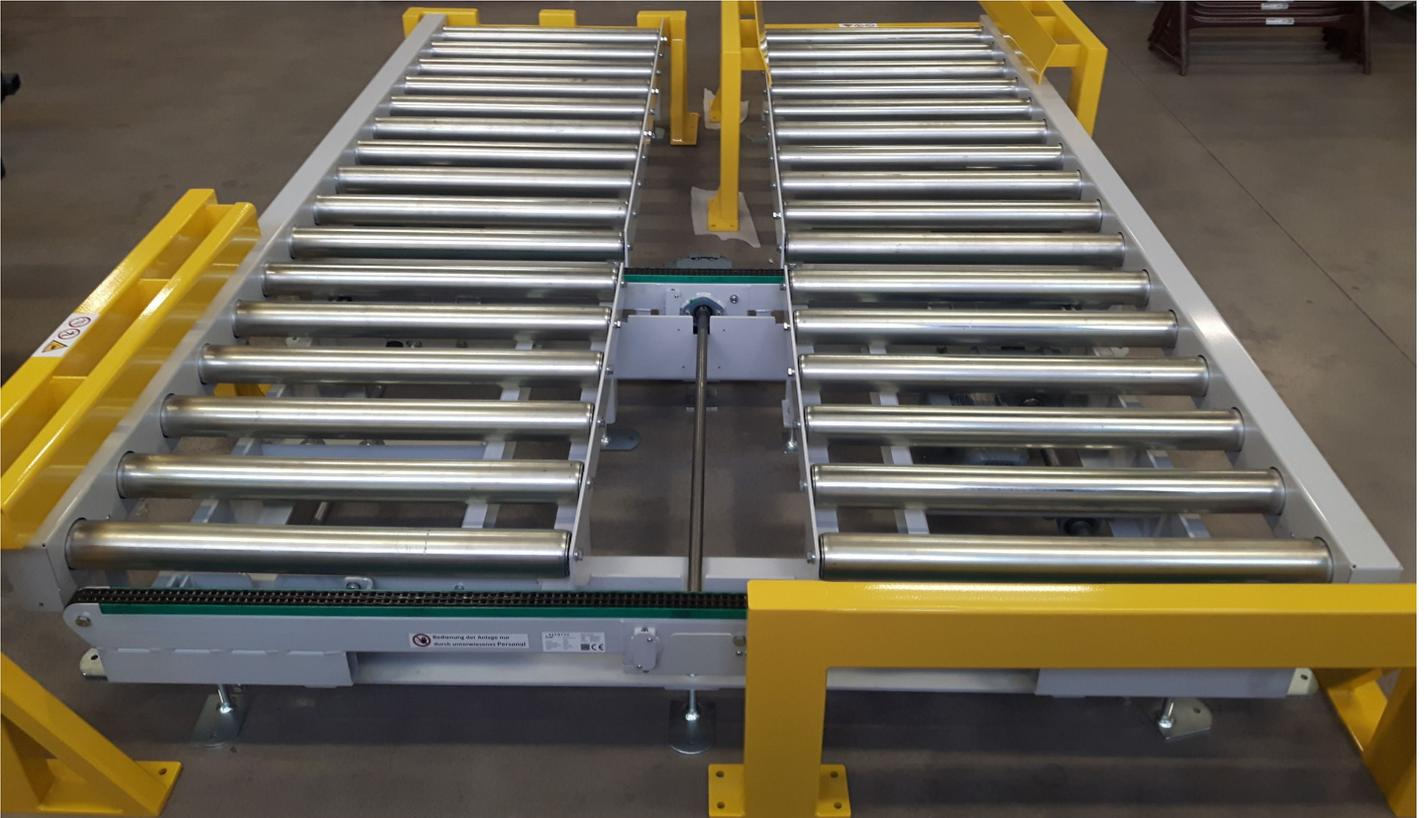
Rollenförderer für Palettentransport, mit integriertem Kettenausschleuser, Zentrierhilfe für die Aufgabe und Rammbock für die Abnahme
