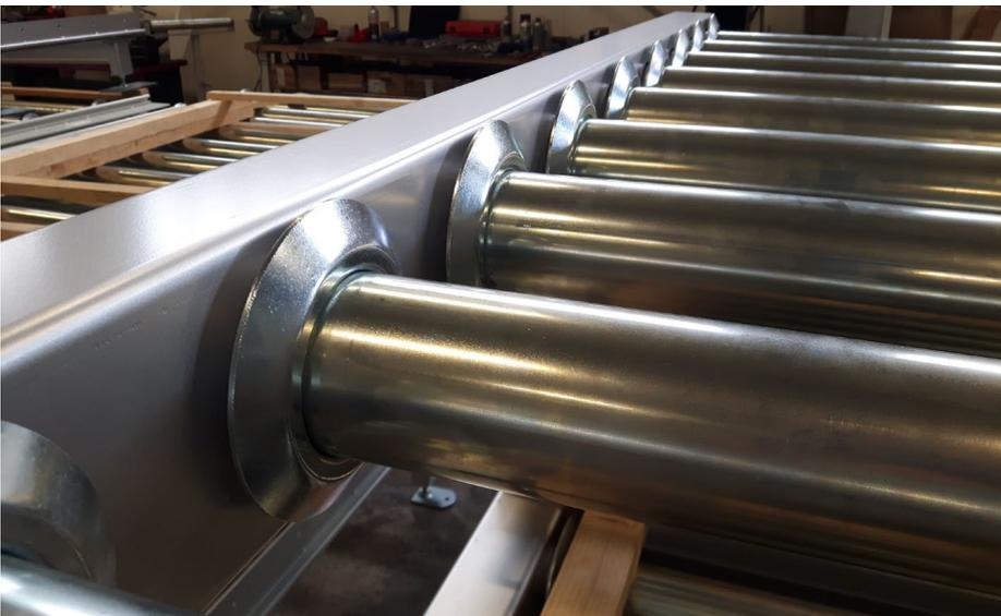
Rollenförderer inkl. Tragrollen mit Spurkränzen für ein optimal geführtes Fördergut
