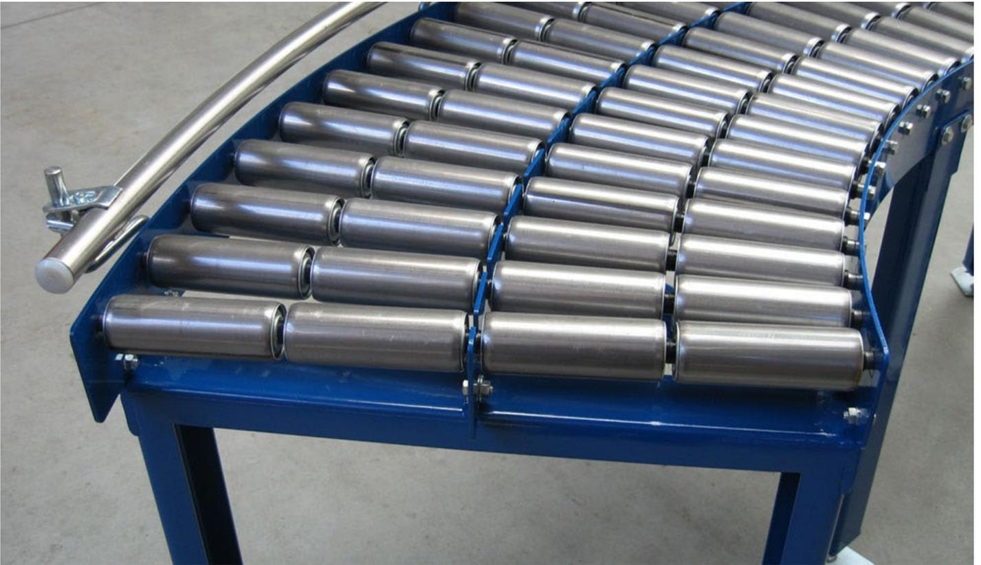
Ausführung mit mehreren zylindrischen Tragrollen auf einer Achse und einer verstellbarer Seitenführung aus Rundrohr
