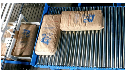
Nach der Lagenbildung fährt ein Rechen in die Aussparungen des Sammelplatzes
