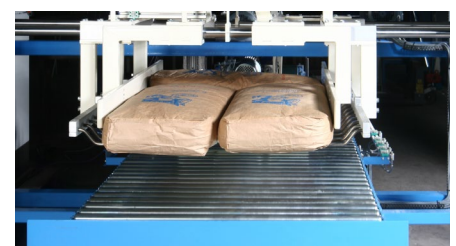
Die komplette Packlage wird in einem Schritt auf der Palette abgelegt
