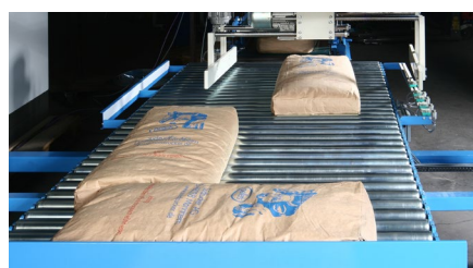
Vorher verschiebt bzw. dreht ein Greifer die Packstücke in die korrekte Position
