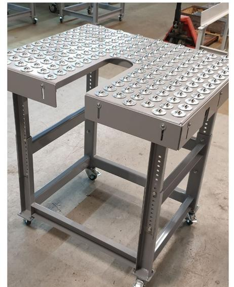
Sonderkugelrollentisch mit Aussparung und verstellbare Seitenführung rundum
