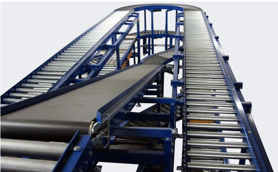
Steiggurtförderer in eine Förderanlage für mittelschwere Fördergüter
