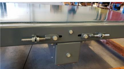
Gurtförderer mit Omega-Antrieb für den Reversierbetrieb inkl. Gurtspannung
