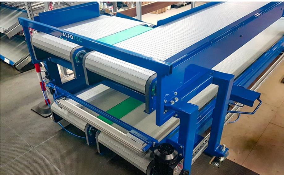
Parallel laufende Strecken mit einer pneumatischen Umsetzung über Linearführungen
