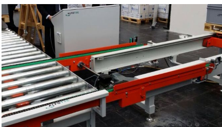
Übergabe von Rollenbahn / Kettenausschleuser auf Flexshuttle
