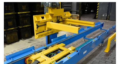
Shuttle-Schlitten als Zuführung zu einem Säulenheber mit Greifern
