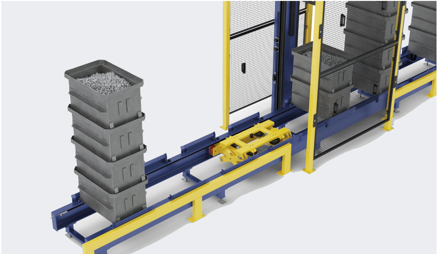
Reines Puffersystem für gestapelte Kisten bis zu 2.000 kg pro Stapel, inkl. Stapleranfahrtschutz für die Aufgabe oder Abnahme
