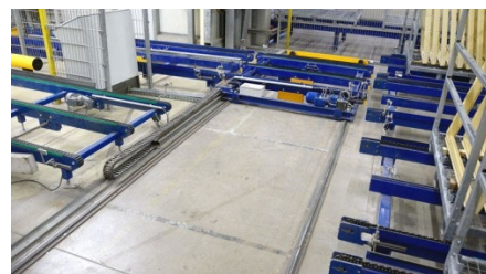
Rangierbahnhof mit Kettenförderern
