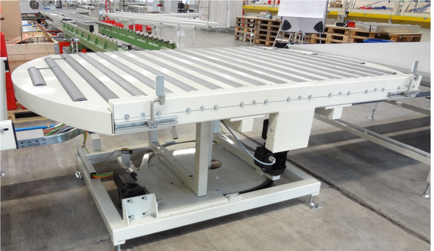
Drehbühne in Fertigungslinie integriert mit Stahltragrollen und PVC-Überzug zum schonenden Transport von empfindlichen Fördergütern
