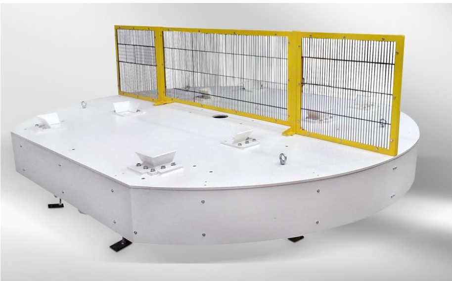
Schwerlastdrehbühne für Sonderpaletten als Wechselmagazin einer Roboterzelle
